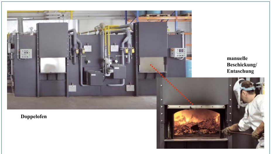
Abb. 2: Doppelbeschickungsöfen, geeignet für den Batch-Betrieb
